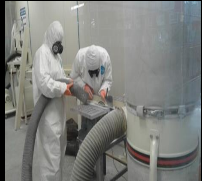
Estudiantes en materiales compuestos cortando fibras.
